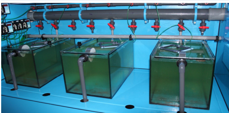
Abbildung 2: Versuchsbecken (90 l) der Kleinkreislaufanlage
